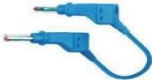
Cordon de mesure extra-souple équipé de deux fiches bananes sécurité à fourreau rétractable et à reprise arrière. 600 V CAT II – Intensité 15 à 32 Ampères selon section
