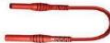
Cordon sécurité 4 mm extra-souple équipé d'une fiche mâle sécurité et d'une fiche femelle sécurité. Câble PVC 0.75 mm 2 1000 V, CAT II, 15 A
