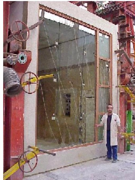
**Essai de résistance au feu d'une façade vitrée**
