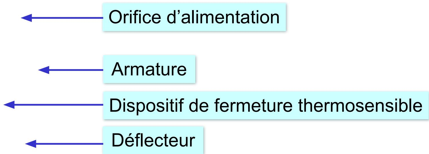
Température de déclenchement 57 ° C à 343 ° C
